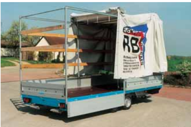
Typ SP mit Aluminiumrampen und mit Faltverdeckgestell , für Kranverladung geeignet, als Zubehör, dazu Bordwände mit Mittelrungen .
