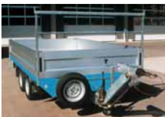
SP mit Bereifung 155/70R12 mit Zubehör: Höhenverstellbare Auflaufbremse mit DIN-Zugöse , wechselbar gegen Kugelkupplung, Ersatzrad vorne montiert wegen Klappstützen hinten, H-Galerie mit Holzeinlage.
