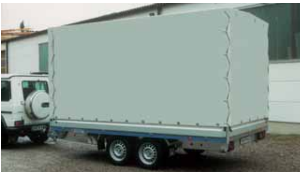
SP Zubehör PVC-Plane und Dachgestell aus verzinktem Vierkantrrohr geschraubt mit 100mm Steigung. Besonders zu empfehlen ist, wenn das Dachgestell und die Plane als Schiebeplane ausgerüstet werden. Die Schiebeplane mit Leichtlaufrollen aus Metall läßt sich spielend leicht nach vorne ziehen, der Anhänger ist schneller offen. Bei normaler Plane lässt sich eine große Plane nur schwer nach oben werfen und der Wind weht sie leicht wieder herunter. Jede Höhe für Anhänger lieferbar, jedoch nicht mit einschiebbarer Plane (Kasackplane) und nicht mit Zollverschluß.
