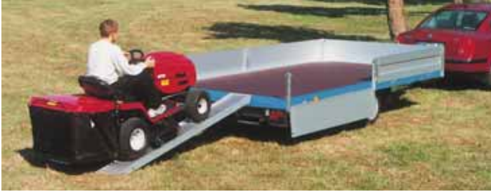
TP 3502 serienmäßig: Mit patentierter Außenrahmenladungssicherung TOPZURR® 21 rundherum. Eloxierete Aluminium-Bordwände, ringsum abklappbar und abnehmbar, Eckrungen steckbar, Ladehöhe 680 mm. Zubehör: Aluminium-Auffahrampen 2500 x 350 mm mit Rampenhalterungen unter dem Anhänger, Klappstützen, Bordwände seitlich in der Mitte mit steckbarer Mittelrune geteilt.
