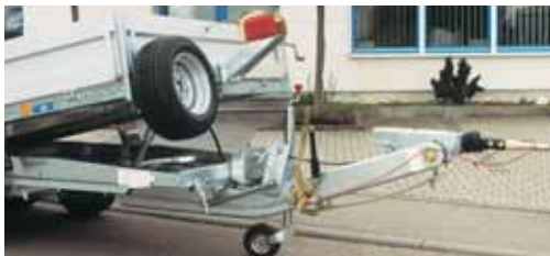
Problemloses Wechseln zwischen verschiedenen Zugfahrzeugen durch höhenverstellbare Auflaufbremse mit LKW-DIN-Zugöse (auf Wunsch mit Kugelkupplung zum Wechseln). Beim TK hebt sich die Seilwinde mit Windenbock mit der Brücke , (Windenbock nicht seitlich verstellbar) Zugseil durch die Stirnwand geführt, Stirnwand dadurch starr. Ersatzrad mit Halterung.
