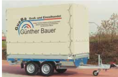
Einschiebbares Dachgestell und PVC-Plane als Zubehör. Linke und rechte Abbildung: ausgezogen auf 2100 mm Ladehöhe. Mittlere Abbildung: eingeschoben auf 1600 mm Ladehöhe. Es werden alle 4 Eckpfosten oben eingeschoben, deshalb ist nicht die ganze Last des Daches zu bewegen. Die Plane hat 2 Reihen Befestigungsösen rundum. Bei eingeschobenem Dachgestell wird der untere Teil der Plane nach innen hochgeklappt und mit Klettverschluß befestigt (Kasackausführung). Die Plane wird dann mit den oberen Ösen montiert.
