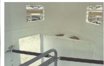
Zweiteilige Futterkrippe, vordere Brustrohre mit Paniksicherung (von außen zu öffnen).
