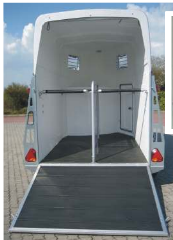
Zweiteilige Futterkrippe, vordere Brustrohre mit Paniksicherung (von außen zu öffnen).
