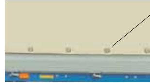
PVC-Planen am ECO unten mit Planendrehverschlüssen anstatt Expanderseil wie bei Typ SP gegen Mehrpreis möglich.
