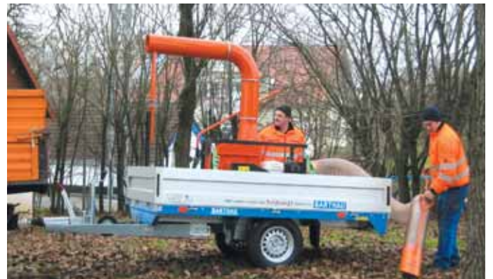
Kommunalfahrzeug , dieser Anhänger ganzjährig für viele Transporte einsetzbar. Der Laubsauger ist mit TOPZURR® 21 jederzeit leicht abnehmbar.
