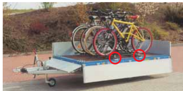
ECO-Toplader mit Zubehör Lastenträger am seitlichen Zurrprofil festgeklemmt. Am Lastenträger können bis zu 9 Fahrradträger montiert werden. Die Lenker dürfen nicht überstehen, sondern müssen an den beiden äußeren Fahrrädern gedreht werden.
