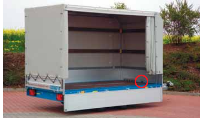
Zubehör Dachgestell und PVC-Plane für ET / EH und RT / RH serienmäßig vorne abgeschrägt. PVC-Plane mit Schnellverschluss unten rundherum mit dickem dauerelastischem Expanderseil. Das Seil wird nur eingehängt. Die Ecken mit Zickzackverschluss . Leicht zu bedienen auch von kleinen Leuten. Schiebeplane von der Schräge nach hinten ist rechts oder links als Zubehör lieferbar.
