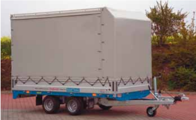
Zubehör Dachgestell und PVC-Plane für ET / EH und RT / RH serienmäßig vorne abgeschrägt. PVC-Plane mit Schnellverschluss unten rundherum mit dickem dauerelastischem Expanderseil. Das Seil wird nur eingehängt. Die Ecken mit Zickzackverschluss . Leicht zu bedienen auch von kleinen Leuten. Schiebeplane von der Schräge nach hinten ist rechts oder links als Zubehör lieferbar.
